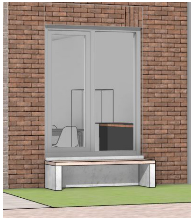
optie 5 - levensloopbestendige woning rij 3 hoogte = 400mm ok. kozijn = 450mm
