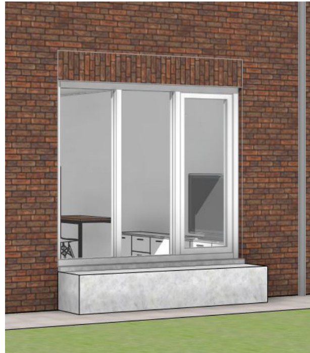
optie 1 - eengezinswoningen hoogte bankje = 400mm ok. kozijn = 450mm
