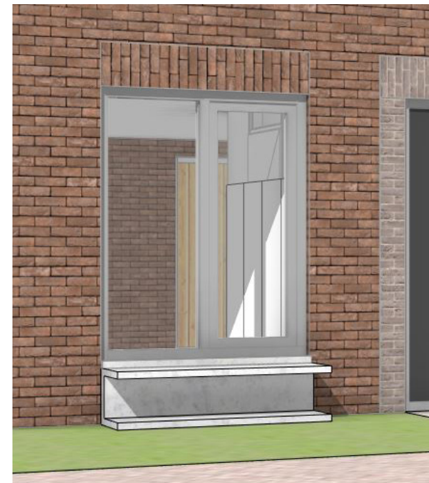
optie 6 - levensloopbestendige woning rij 5 hoogte = 400mm ok. kozijn = 450mm
