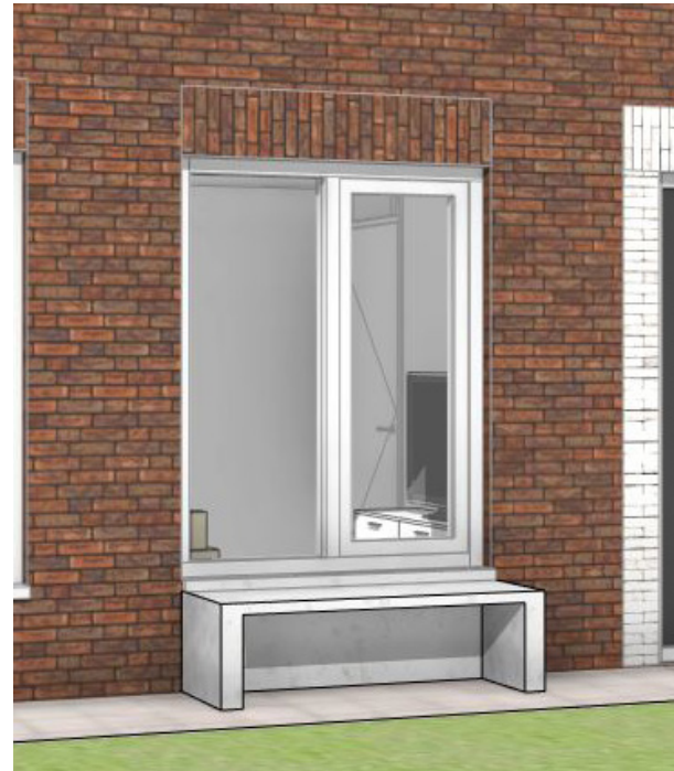
optie 2 - nultredenwoning dwarskap hoogte = 450mm ok. kozijn = 500mm
