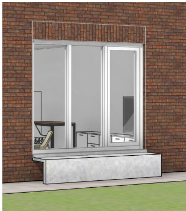
optie 4 - levensloopbestendige woning hoogte = 400mm ok. kozijn = 450mm
