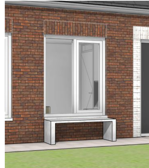
optie 3 - nultredenwoning langskap hoogte = 500mm ok. kozijn = 550mm
